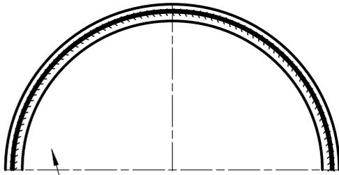
継手受け口奥側面と塩ビ板を溶接
